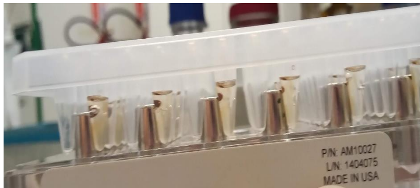
Figura 7: Placa de 96 poços acoplada a uma placa magnética durante a purificação das bibliotecas. Fonte: Arquivo pessoal.
