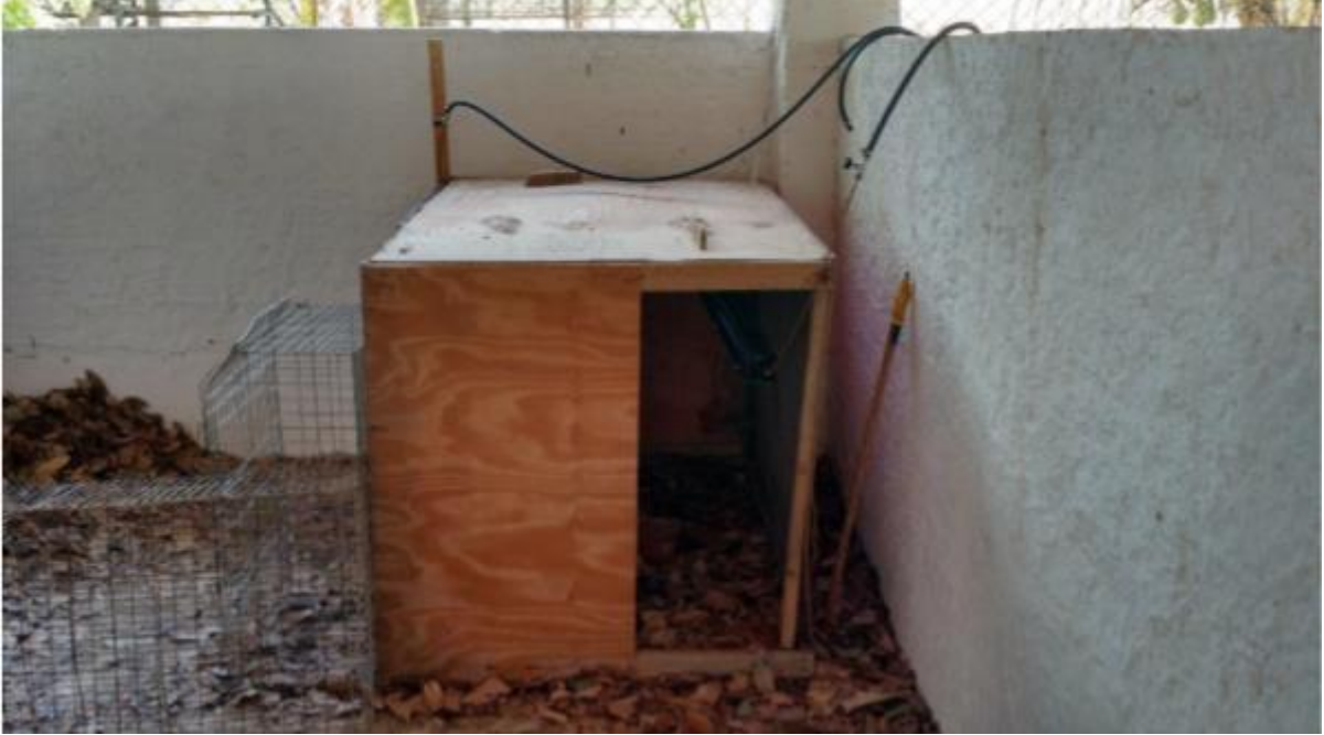
Figura 3. Box experimental de aquecimento utilizado para a realização do estresse térmico nas aves.
